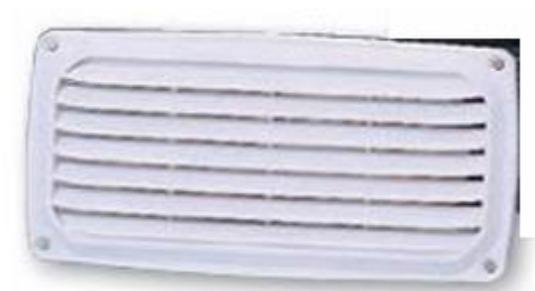
200×100の開口部の加工は4隅を10mmのドリルで穴を開け、電動糸鋸で切断する。ビス4本でとめる。
